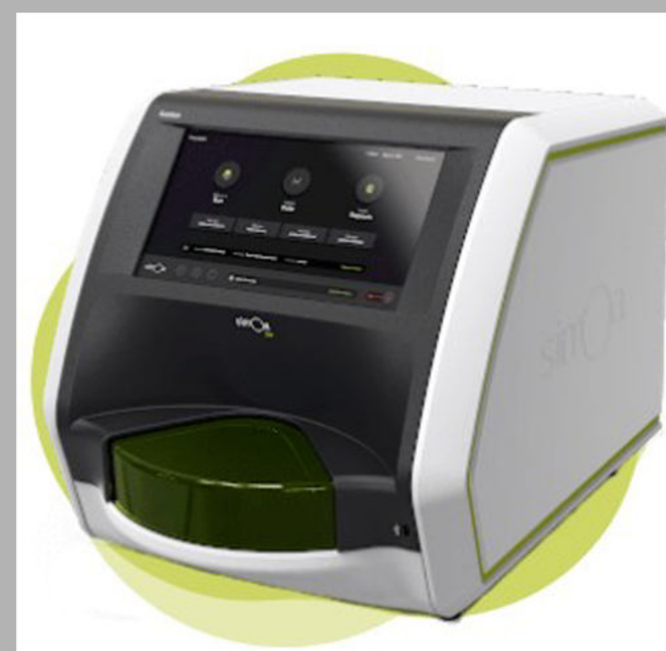
Abb 1 SR X™ Biomarker Detection system Semi automatische Analyse von Proben mittels single molecule array (Simoa® SR X™ links) Mit Substrat (z B CGRP) beladene Beads fallen in Vertiefungen der Microwells und werden gemessen.
